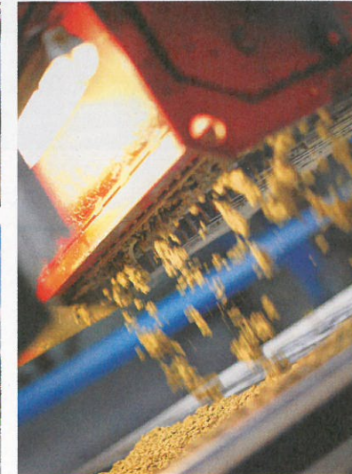
Johannes Bürkle setzt in der Produktion auf Präzision. Vollautomatisch wird der Beton in die vorbereiteten Paletten eingefüllt (links). Alle 10 Minuten ist ein neues Element fertig, überwacht durch moderne Computertechnik (links oben). Die fertigen Bauteile werden auf der Baustelle innerhalb einer Woche montiert, natürlich auch in Hanglagen (ganz links).
